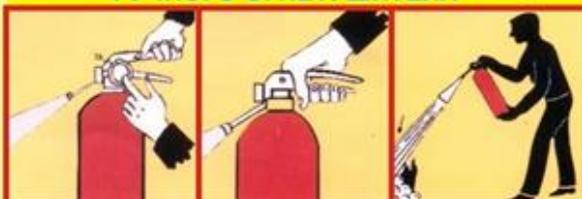
Снять огнетушитель, сорвать пломбу, выдернуть чеку. Привести раструб в горизонтальное положение и нажать на рычаг. Направить струю заряда на огонь.
