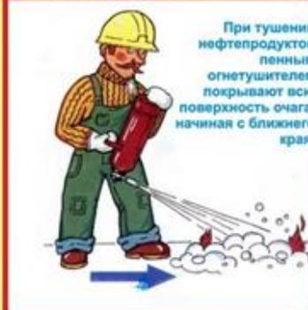
При тушении нефтепродуктов пенным огнетушителем покрывают всю поверхность очага, начиная с ближнего края.
